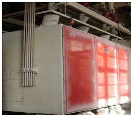
La séparation du son et des autres produits de la mouture est appelée « blutage » : elle est réalisée au moyen de tamis vibrants circulairement dans un plan, les « Planschister ». Différentes tailles de maillages permettent de trier de façon optimale. Le produit plus fin revient gravitairement vers le moulin suivant pour un broyage plus poussé.
